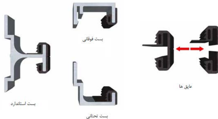
شکل ۷-۵- نصب درزپوش بر روی مهارها
